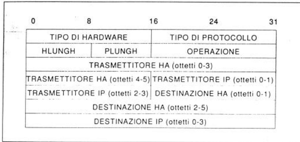
**Fig. 5.3** Un esempio del formato del messaggio ARP/RARP quando è usato per la risoluzione degli indirizzi da IP a Ethernet. La lunghezza dei campi dipende dalle lunghezze degli indirizzi hardware e del protocollo, che sono di 6 ottetti per un indirizzo Ethernet e di 4 ottetti per un indirizzo IP.
