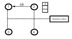
quando il processo nella SC esce dalla sezione critica, manda 'OK' al processo in coda
