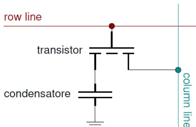
Come mostrato in figura, l'*informazione binaria* è immagazzinata in unità che consistono in un *transistor* e in un piccolissimo *condensatore* del valore di circa 20÷40 fF (Femtofarad, 0.020-0.040 pF) per ogni cella. Un condensatore carico ha valore logico 1, uno scarico ha valore logico 0.
