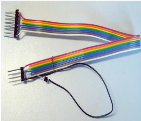
Le due schede fornite lavorano in sinergia e devono essere opportunamente collegate per funzionare correttamente. Per il collegamento delle due schede si utilizzi il cavo a 4 poli fornito. Come da figura in appendice collegare, ad alimentazione scollegata, prima il terminale "A" sulla "Scheda di Visualizzazione", e successivamente il terminale "B" alla "Scheda Xess"; in entrambi in casi prestare attenzione a rispettare il "pin constraint".
