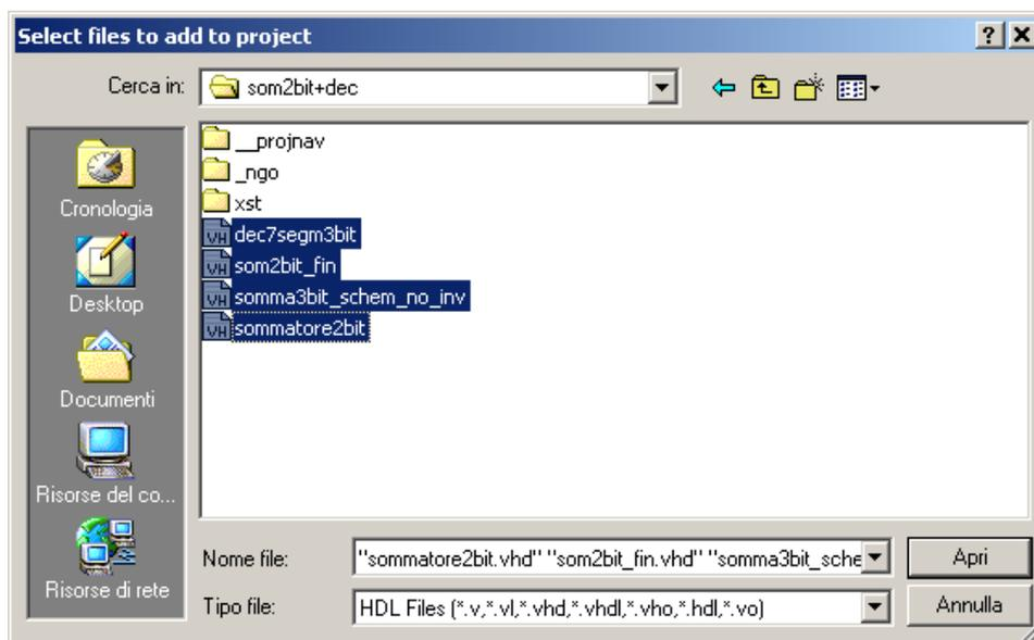
Attenzione: come intuibile, non è possibile aggiungere e quindi simulare solo il top file del progetto (nel nostro caso 'som2bit\_fin') in quanto mancano i riferimenti ai simboli usati (quelli da noi creati, come 'dec7segm3bit'). Si verificheranno degli errori nei passi successivi della simulazione.
