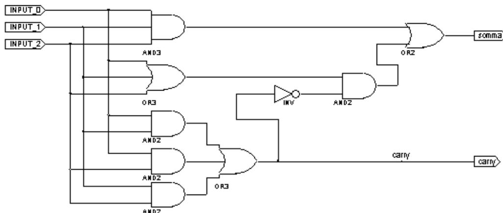
Nel rimuovere gli invertitori dal vecchio schematico, si faccia attenzione alla polarità degli Input Marker: deve essere 'Input'; per verificare è sufficiente fare doppio click sul simbolo dell' I/O Marker e controllare la 'Port Polarity':
