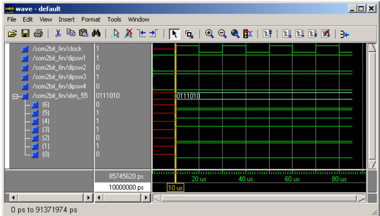
Com'è visibile il circuito, in questo caso, reagisce dopo 10 $\mu$ s dall'inizio della simulazione. Ponendo a 1 i segnali che accendono i led s1, s3, s2, s5. Controlliamo se il risultato di  $10 + 10 = 4$  è visualizzato correttamente.
