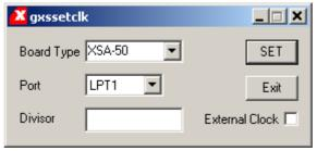
I parametri relativi al tipo di scheda e alla porta parallela sono gli stessi visti sopra. Per i nostri scopi sarà utile impostare un divisore di 2052 allo scopo di avere un clock di sistema di 48.7 kHZ.
