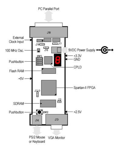
Collegare la XSA Board al PC: collegheremo un'estremità del cavo parallelo (in dotazione) al PC e l'altra al connettore J8 della scheda (vedi figura).
