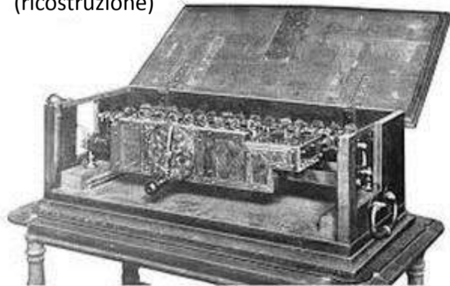
Step Reckoner (per le moltiplicazioni) LEIBNIZ, 1672-94 Questa macchina usa numeri decimali, ma Leibniz credeva nel sistema binario
